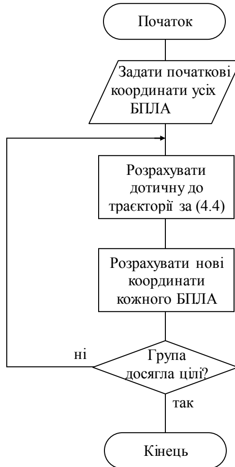
Рис. 4.4 Алгоритм керування рухом групи БПЛА заданою траєкторією у найпростішому випадку – без перешкод та інших зовнішніх збурень
